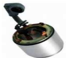
CARCAZA Con CAMPOS Tipo DENSO 12v.1kw FIAT KUBOTA Largo Total 62.5 Diametro 63.7
