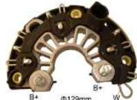
Placa Rectificadora T. BOSCH (D) 6 Diodos M8 129mm. Con Salida Tac. M.BENZ
