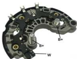
Placa Rectificadora T. DELCO REMI KOREA 6 Diodos M8 CHEVROLET SAFIRA
