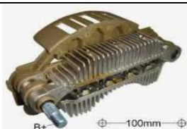
Placa Tipo MITSUBISHI 100 mm. 8 Diodos M5 CITROEN C3 - PEUGEOT 307/308 A3TG0081
