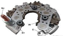
Placa Tipo DENSO 12diodos 134mm. 104210-6191 HYUNDAI GENESIS
