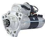
Arranque T. DENSO 24v. Z10 7kw CATERPILLAR 950GC 938M 428000-9120
