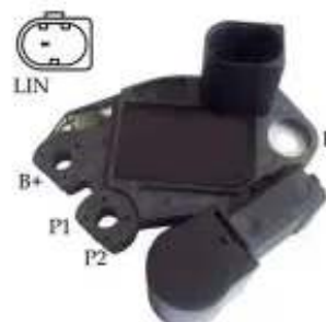
Regulador T VALEO 599236-2618713 Alt. N° FG15T036 M. BENZ , VW AMAROK V6 "LIN" ID 73
