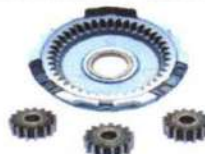
Planetario Tipo ISKRA 42 dientes JCB 524-20 11131848
