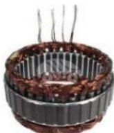
Estator Tipo MITSUBISHI 24v. 100amp. SCANIA 114
