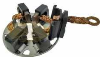
PORTA CARBON Tipo DENSO BC 438000 VW GOL - VOYAGE - UP
