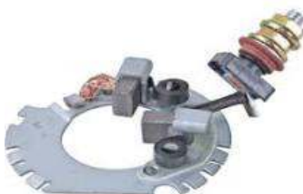
Porta Carbon Tipo DENSO 028510-0632-5270 MOTOCICLETAS ZR1000
