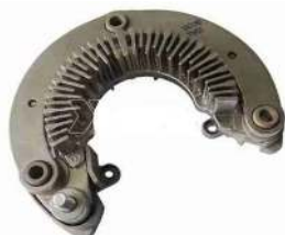
Placa Tipo MITSUBISHI ,Alternador 12v. 110amp N° A5TL0581ZC HONDA ACCORD 2013-2017
